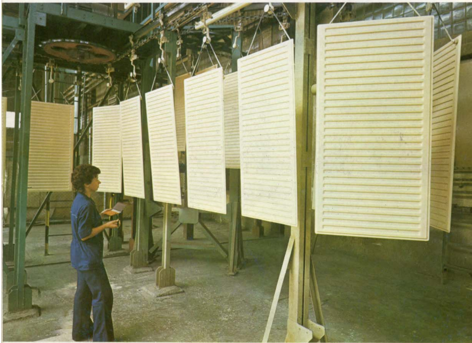
Kontrola povrchu ocelových doskových radiátorov
